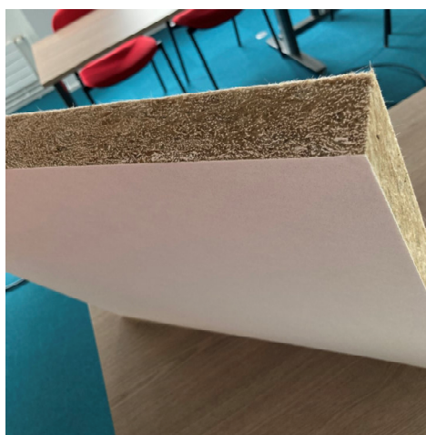
Photographie n°9 Dalles faux plfond 600*600 Rockfon Ekla 40 mm
